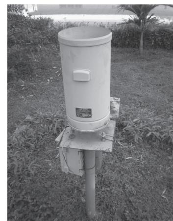
図 2：Acacia Center に設置されている転倒ます型雨量計
