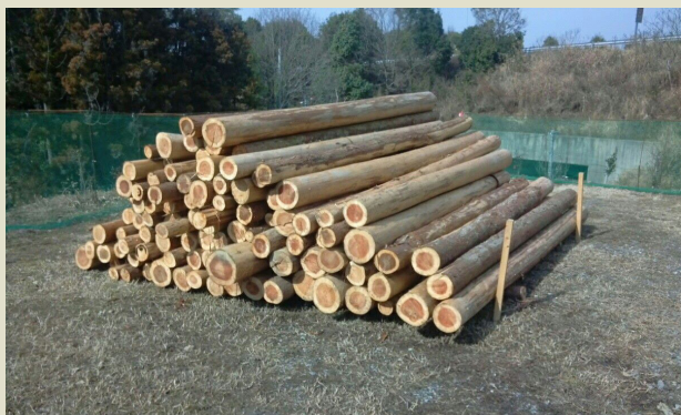
写真2：山中から搬出されて積み上げられた材木。反りや割れはほとんど見られず、葉枯らし乾燥の有用性を確認できた。(写真提供 河原林 洋氏)
