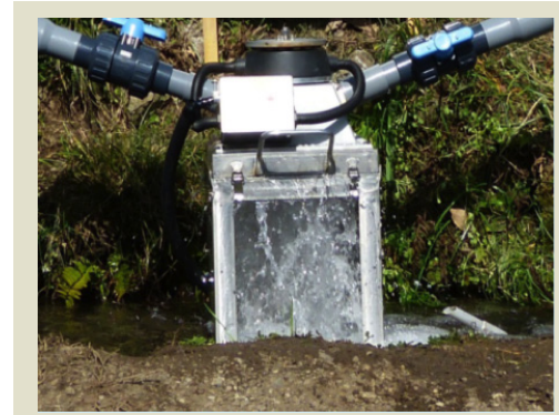
写真：カナダ製の小型水車・発電機。20万円。2本のパイプで水を噴射して発電する。水を引く落差は10m以上が望ましい。1.5kWまでの発電力をもつ。
