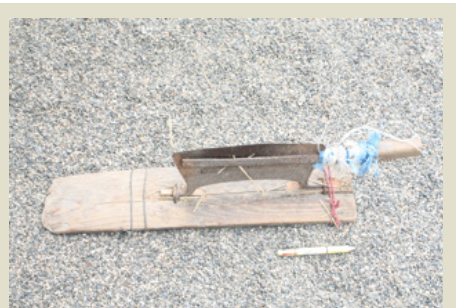
写真 1：押し切り 台の長さ 63cm、幅 15cm。刃 30cm。柄の長さ 20cm。
