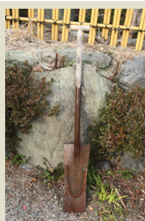
写真3：平鋤 長さ115cm。幅上辺15cm、下辺14cm、高さ43cm。柄の直径3.5cm。握り手の長さ12cm。
