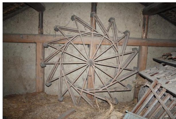
水車：集落の小屋にあった羽根車。 直径 2.4m、羽根板は 15 枚。
