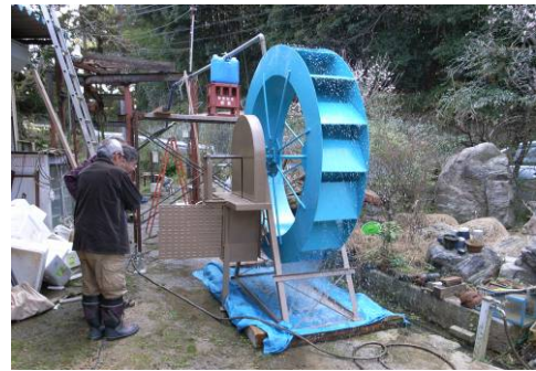
でき上がった水車発電システム。まずは、ホースで水をかけて稼働実験。
