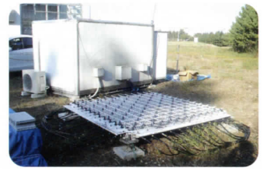
サイト型機動研究: ウインドプロファイラーによる観測(青森県) Atmospheric Observations with Wind Profiler (Aomori Site)
