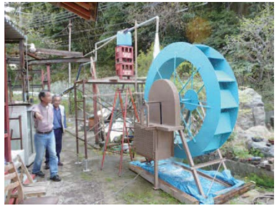
写真6 製作した水車の発電テスト
