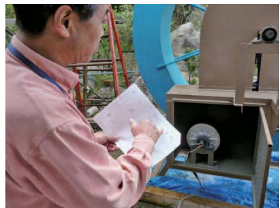
写真7 アウターローター・コアレス発電機 (水車側面のボックス内部に設置)
